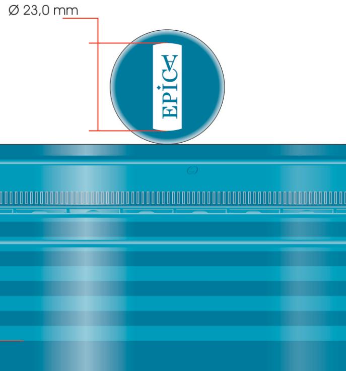
Tolerancia màxima de superposicion / junta = 3 mm
