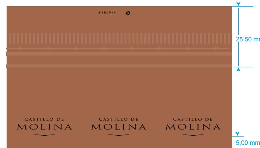
tolerancia de posición del diseño: FALDA +/- 1 mm CABEZA +/- 1.5 mm
