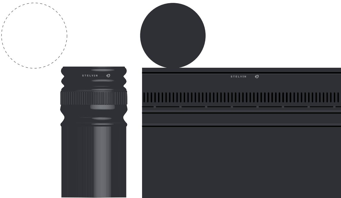
tolerancia de posición de diseño: +/- 1 mm
