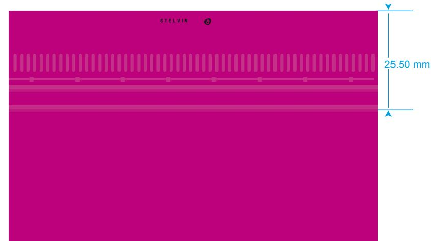
tolerancia de posición del diseño: FALDA +/- 1 mm CABEZA +/- 1.5 mm
