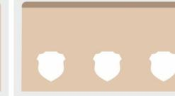
Máxima tolerancia des centrado troquel 1 mm.
