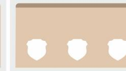
Máxima tolerancia descentrado troquel  $1$  mm.
