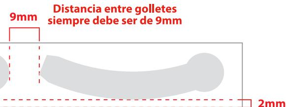
Distancia entre la base del rollo y la base de la etiqueta siempre debe ser de 2mm
