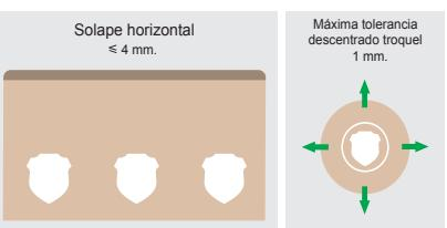
Máxima tolerancia descentrado troquel 1 mm.
