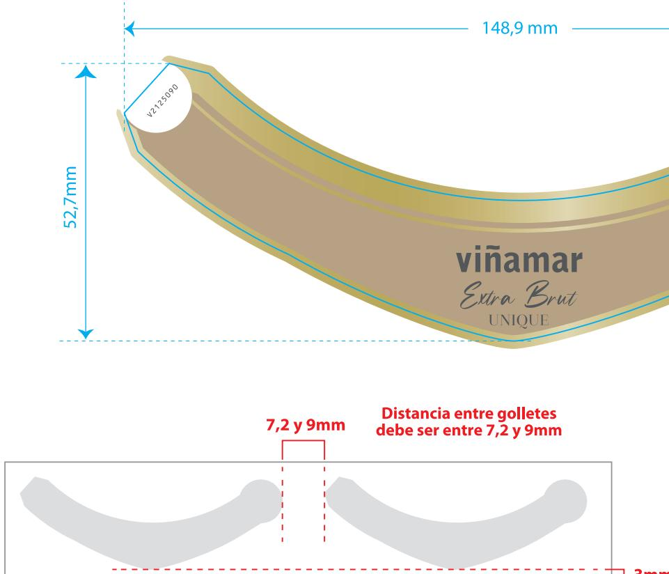
Distancia entre la base del rollo y la base de la etiqueta siempre debe ser de 3mm
