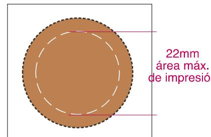
Las tolerancias de corte y de formado son de +/- 1mm con relación al diseño y todas esas tolerancias pueden adicionarse
