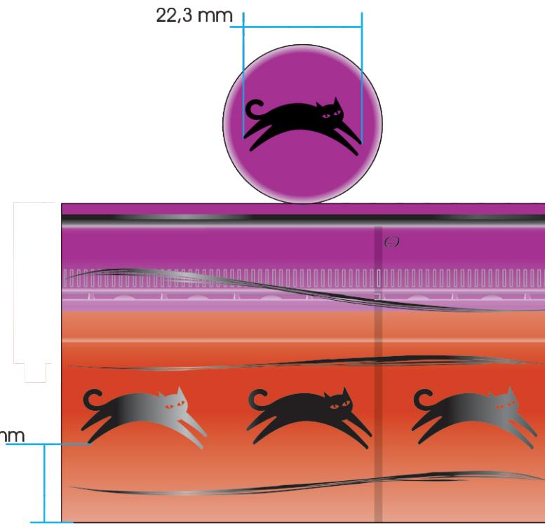
Tolerancia màxima de superposicion / junta = 3 mm
