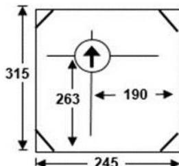
**LARGO:** 315 mm**ANCHO:** 245 mm**TOLERANCIA:**  $\pm$  10 mm**ORIENTACIÓN DE LA BOQUILLA:** 180°**ALTURA DE LA BOQUILLA:** 263 mm**DISTANCIA DEL SELLO:** 190 mm**TIPO DE ESTERILIZACIÓN:** N/A**LEYENDA:**
