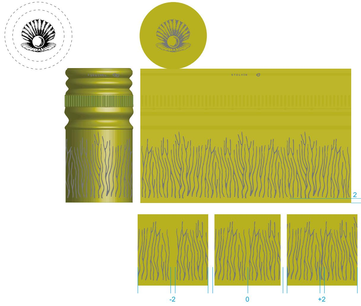
tolerancia de posición de diseño : + / - 2 mm
