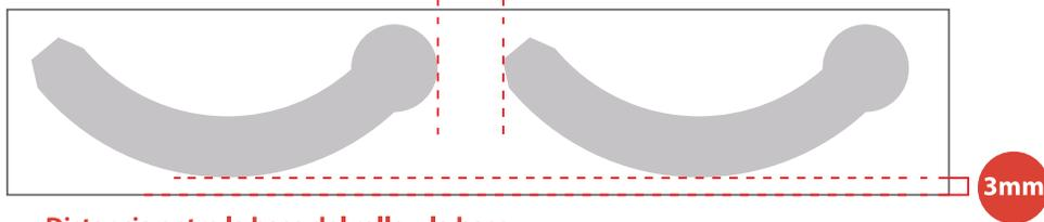
Distancia entre la base del rollo y la base de la etiqueta siempre debe ser de 3mm
