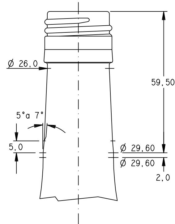
(M) MODIFICACION DE TOLERANCIA A Ø DE FALDA 03-05-2020
